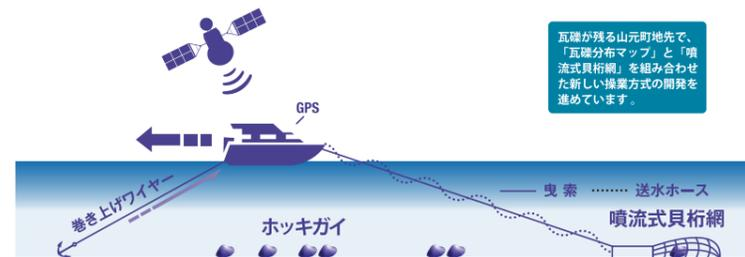
がれき分布マップと噴流式貝桁網を組み合わせたホッキガイの新しい操作方式の模式図
