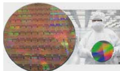
先端企業と互換性を有し、大学が運営する世界唯一のスピントロニクス対応300mmプロセス試作評価ラインで作製された300mmウエハ
