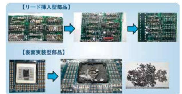
電気パルス破碎による電子基板の粉碎の例
