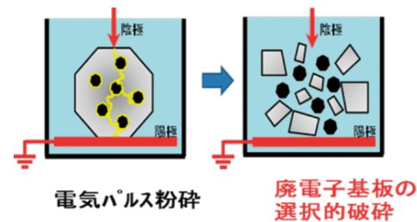
電気パルスによる選択的破碎の模式図
